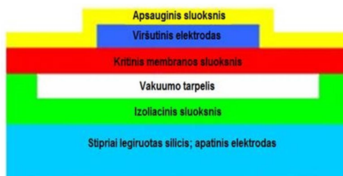
1 pav. CMUT bazinės struktūros vertikalus skerspjūvis
