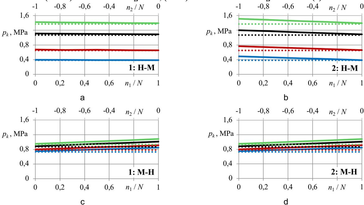
6 Fig. Kontaktinio slėgio  $p_k$  priklausomybė nuo nuokrypių  $n_1$  ir  $n_2$  bei išorinio sluoksnio storio  $s_2$ , kai:  $p_0 = 0$ ;  $N = 0,077$  mm;  $d_2 = 14$  mm;  $s_1 = 0,5$  mm; ■ –  $s_2 = 0,3$  mm; ■ –  $s_2 = 0,5$  mm; ■ –  $s_2 = 0,8$  mm; ■ –  $s_2 = 1,0$  mm; a – 1-o modelio H-M tipas; b – 2-o modelio H-M tipas; c – 1-o modelio M-H tipas; d – 2-o modelio M-H tipas; (—) – apskaičiuota taikant BEM; (····) – apskaičiuota pagal (1) formulę
