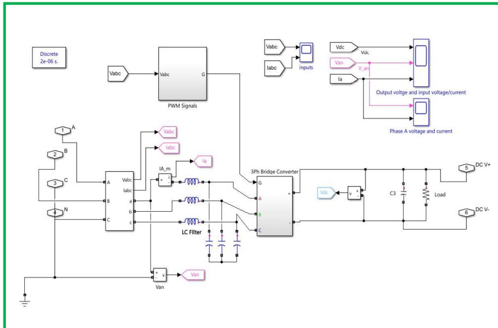
Figure 3. PWM rectifier structure.
